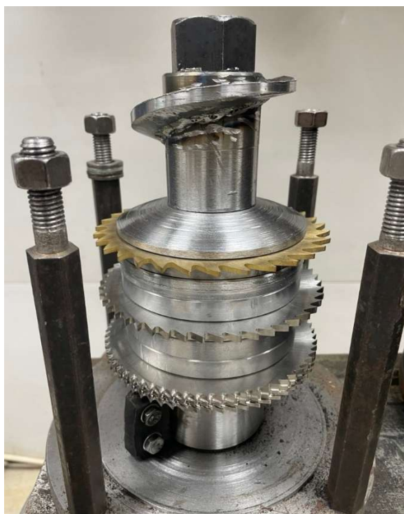
Рисунок 3.8 Ротор с режущими и регулировочными ножами с сборе
