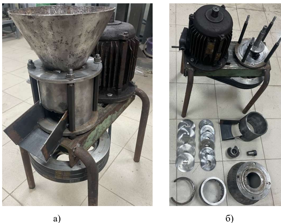
Рисунок 3.2 Измельчитель вертикального типа для переработки резинотехнических отходов: а – вертикальный измельчитель в сборе; б – конструктивные элементы
