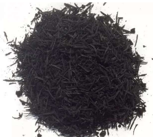
Рисунок 1.4 Крошка по форме «елочная игла» [39]
