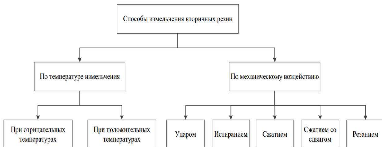
Рисунок 1.14 Схема способов измельчения
