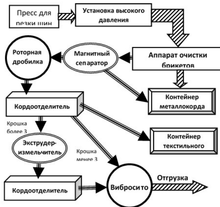
Рисунок 1.18 Схема бародеструкционного метода
