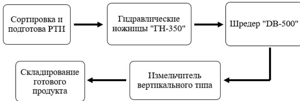
Рисунок 5.1 Схема участка ОАО «Машиностроитель» для переработки РТИ
